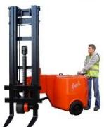
Le dernier-né de la gamme de chariots élévateurs articulés Bendi a vu le jour à l'issue de trois années de développement. Croisement d'un chariot élévateur articulé trois roues et d'un gerbeur accompagnant porte à faux, il permet au cariste de bénéficier d'une visibilité maximale grâce au tablier à déplacement latéral et au mât inclinable. La charge ainsi déportée sur le côté (rotation du mât à 220°) permet au cariste d'effectuer la pose ou la dépose de la palette en toute sécurité.
