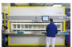
Le gain de vitesse de rotation de ce stockeur industriel peut atteindre +70%. Résultat : une mise à disposition plus rapide des produits, une diminution du temps d'accès moyen de près de 40% et une cadence de préparation optimisée. Côté ergonomie, l'ouverture de prélèvement des pièces s'effectue toujours au même niveau, défini au préalable selon la taille de l'opérateur.
