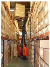
Ce chariot articulé opère dans les allées étroites de 1,60m avec une stabilité optimale, grâce, entre autres, à sa motorisation située à l'avant. Son toit de protection sans montant protège le cariste tout en lui offrant une grande visibilité. Quant à son moteur électrique et au bruit hydraulique, ils ont été réduits, faisant de ce chariot le plus silencieux de sa catégorie.
